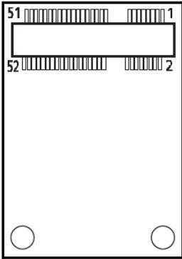
**CN5 : Mini PCI-Express Socket (Support PCIE/ USB3.0/ USB2.0 Interface)**
